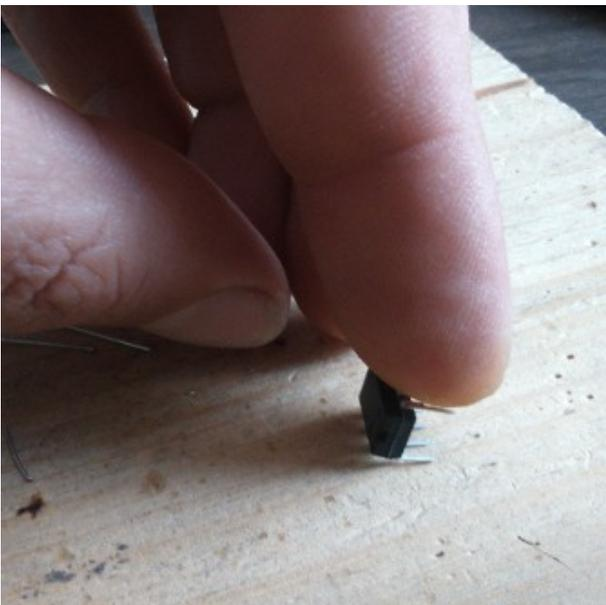
Il ne reste plus qu'à clipper les circuits intégrés (sn65hvd08P et ATmega 328). Les pattes sont parfois un peu écartées et il peut être nécessaire de les resserrer avec les doigts.
