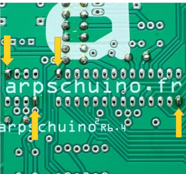
On va ensuite mettre en place les supports de circuits intégrés en faisant bien attention à mettre l'encoche dans le sens indiqué sur la sérigraphie. Pour les mettre en place on commence par faire un point de soudure à chaque extrémité, comme sur la photo.
